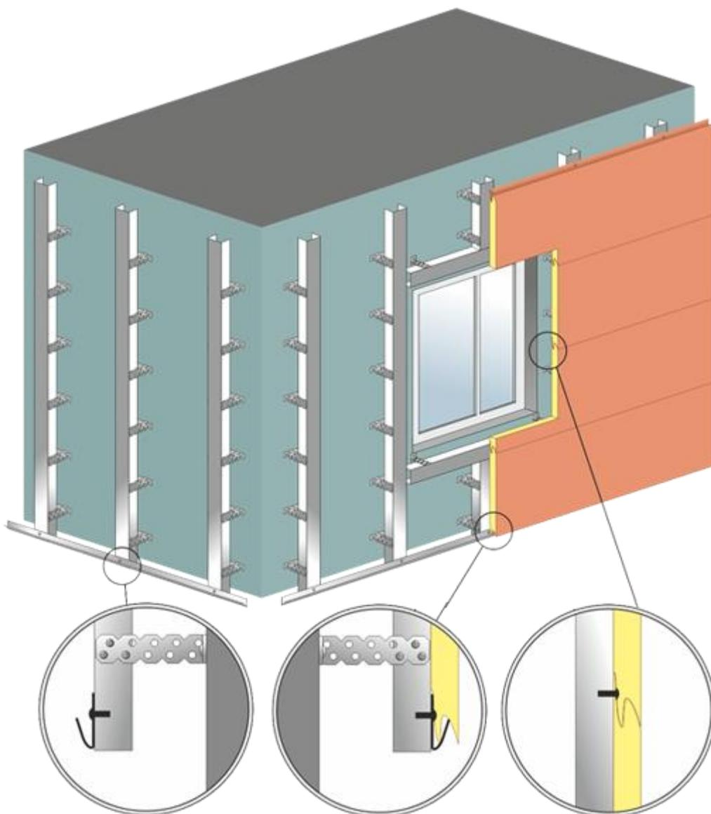
Угловые элементы (внешние и внутренние) применяются оформления угловых стыков панелей. Между собой они соединяются замковым элементом шип-паз. Помимо этого углы можно использовать на стыке подшивки вертикальной стены фронтона и нижней части выступающей крыши, оконных, дверных проемов и т.п. При соединении панелей на углах и стыках рекомендуется оставлять между ними температурный зазор 3-5 мм.
