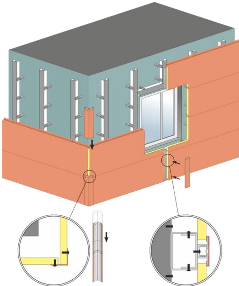
Соединительная планка закрывает соединение панелей в торцевой части. Крепится она следующим образом: между торцевыми краями панелей саморезами крепится п-образная алюминиевая направляющая, которая является ответной частью замка соединительного элемента, а за тем в нее с небольшим усилием вставляется сам соединительный элемент. Между собой по длине элементы соединяются замком шип-паз. Для закрывания среза и крепежа последней панели применяется финишная планка.
